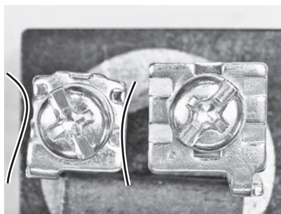
図5 足付き端子ネジ完成品比較 (左：現状装置 右：開発装置)
